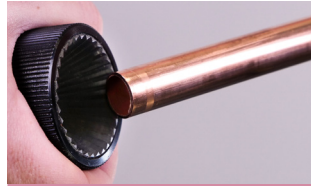
2. Rohr innen und außen entgraten
